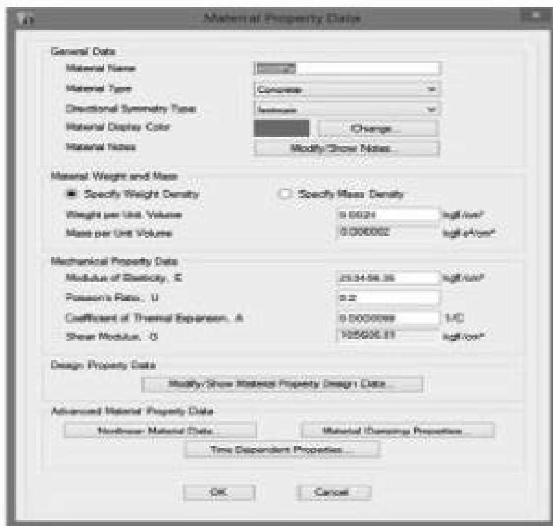
شکل (۱۱): تعریف مشخصات مصالح بتنی
