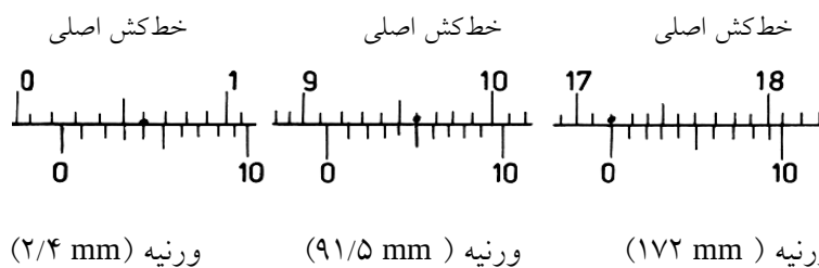
شکل ۱۳-۱ روش خواندن کولیس
