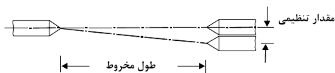
شکل ۳۴- روش مخروط تراشی با انحراف مرغک
